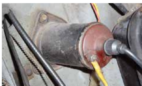
Neu nicht mehr erhältlich: Ein Relikt aus alten Zeiten sind Panzerzündspulen
