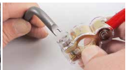
Die Plusklemme des Cadillac-Alarmsystems kann nur mit einem Spezialschlüssel gelöst werden
