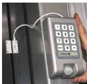
Das mobile GSM-Alarmsystem Mobeye i110 kommt ohne Netzstrom, Telefon und W-Lan aus
