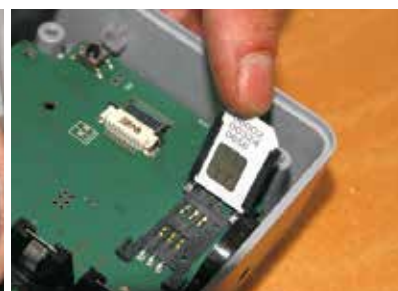
Das Mobeye -Gerät kommuniziert mittels SIM-Karte. Es sendet Alarme und Statusanzeigen über das Mobiltelefon-Netz
